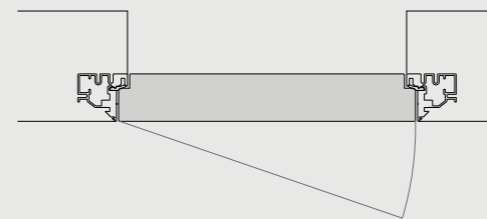
SEZIONE ORIZZONTALE PORTA A TIRARE SX Horizontal section door to pull left
